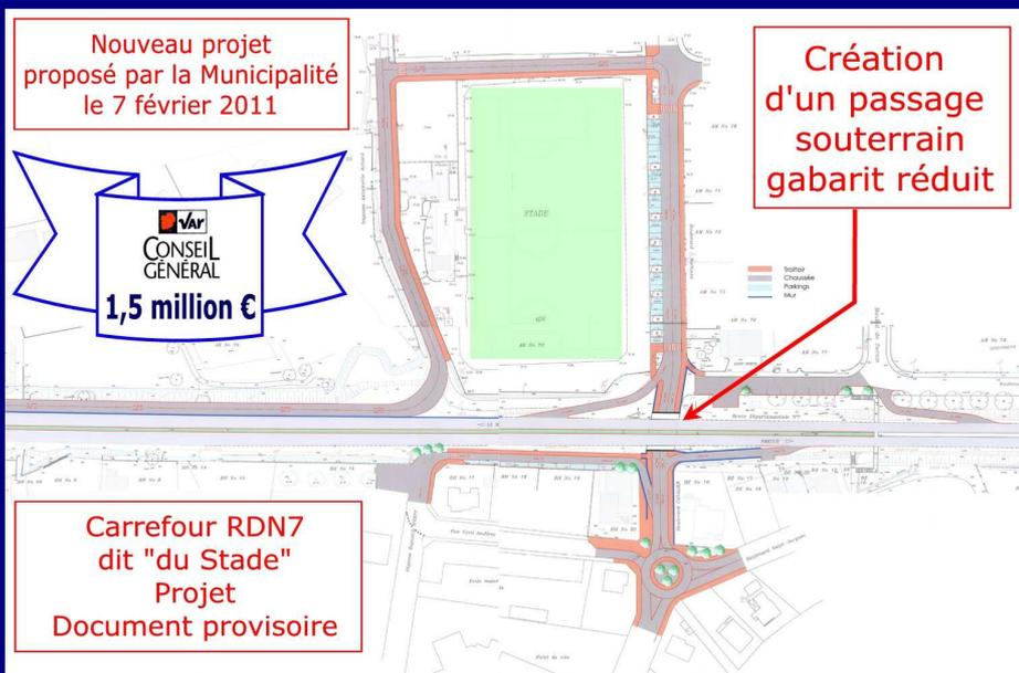
Ci-dessus le nouveau projet visant à mettre en souterrain un passage à gabarit réduit au niveau des feux tricolores du stade ...
